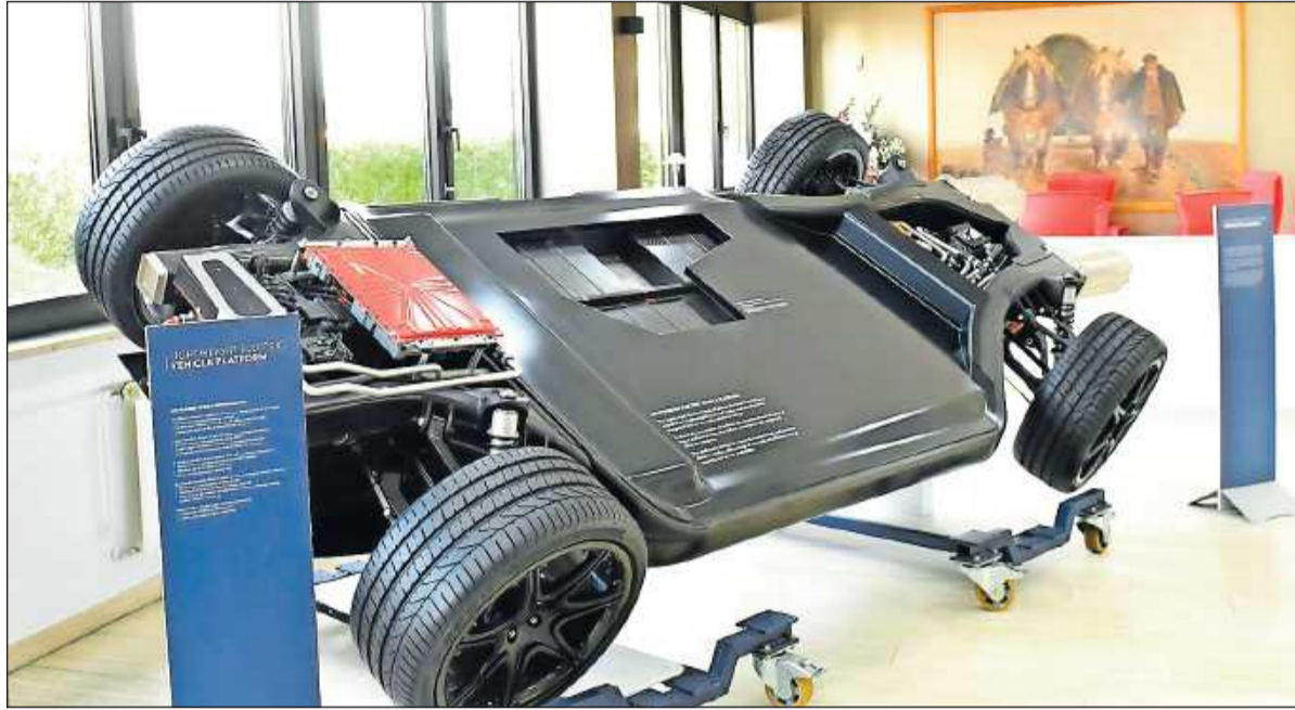
Die Skateboard-Plattform von WAE aus England: Eine Karosserie würde den Unterbau mit Felgen, Elektroantrieb und Batterien zu einem fahrtüchtigen Auto werden lassen. In Bad Dürkheim sollen bis zu 30 Mitarbeitern an neuen Projekten tüfteln.
