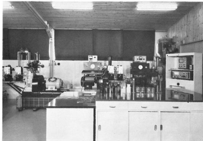
Cetanzahl-Klopfprüfstände (Cetanzahlbestimmung mit iG/BASF-Prüfmotoren)
